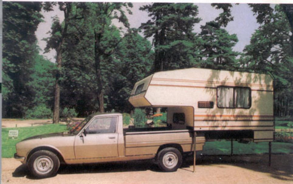
La rétraction totale du système de manutention abaisse le plancher à environ 30 cm du sol, pour utiliser la caravane seule. Un marche-pied escamotable permet un accès facile à la porte arrière.
